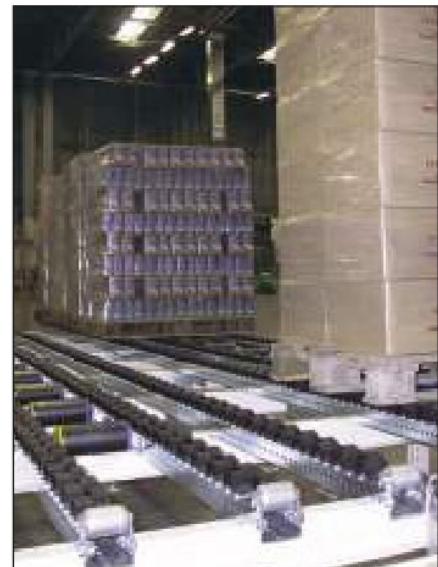
Dettaglio rullivia per pallets, stoccati con slitte di scorrimento parallele ai rulli di linea Across batten conveying for non standard pallets
